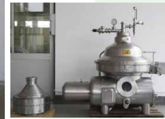
COD.032 - SCREMATRICE CENTRIFUGA AUTOPULENTE MARCA WESTFALIA MODELLO MSA 90-01-076 ANNO DI COSTRUZIONE 1980 PORTATA SCREMATURA LATTE 10.000 L/H
